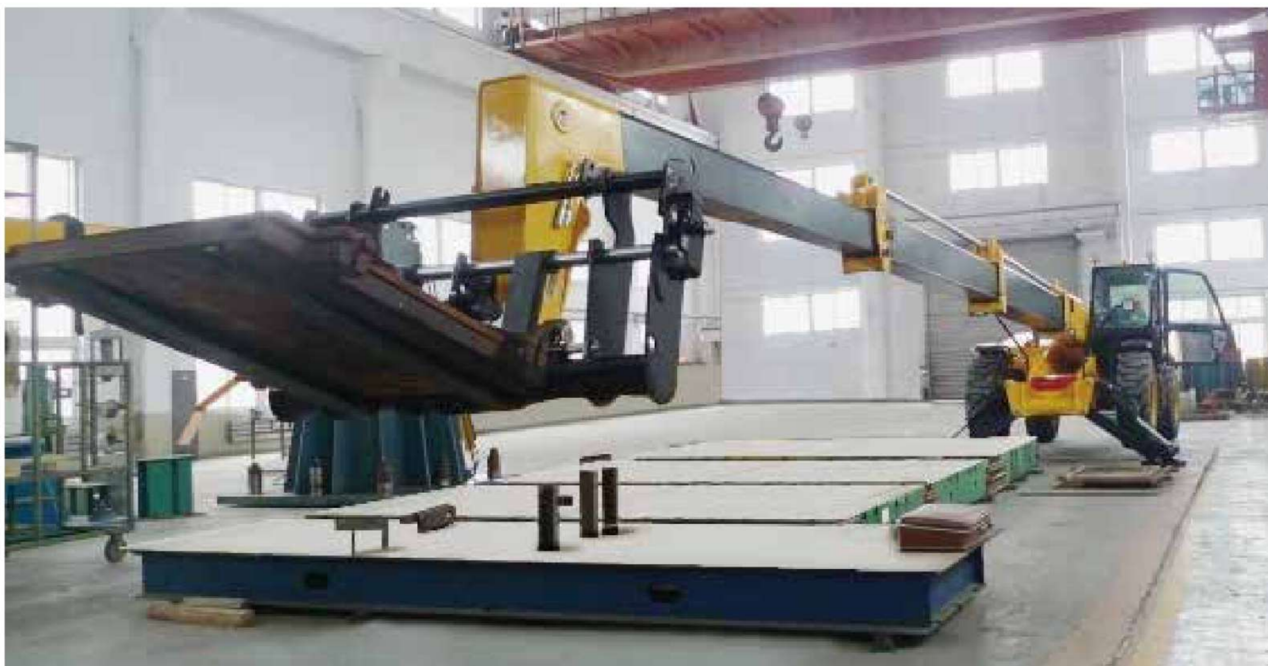
Погрузчик прошел испытания на усталостную нагрузку и перегрузку с применением 200 000 рабочих циклов.
